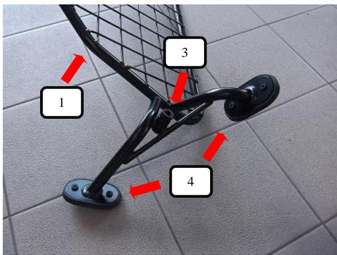
Die GummifüÙe (Pos. 4) auf das Trenngitter (Pos. 1) und die KunststoffhüÙen (Pos. 3) in das Trenngitter (Pos. 1) stecken.
