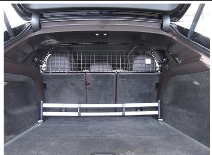
Trenngitter im montierten Zustand.
