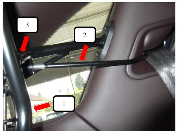
Das Trenngitter (Pos. 1) in das Fahrzeug stellen, so dass es sich an der C-Säule abstützt. Gewindehaken (Pos. 2) durch die KunststoffhüÙen (Pos. 3) und das Trenngitter (Pos. 1) stecken, der Gewindehaken (Pos. 2) muss sich dabei in der Gurtausführung einhaken.
