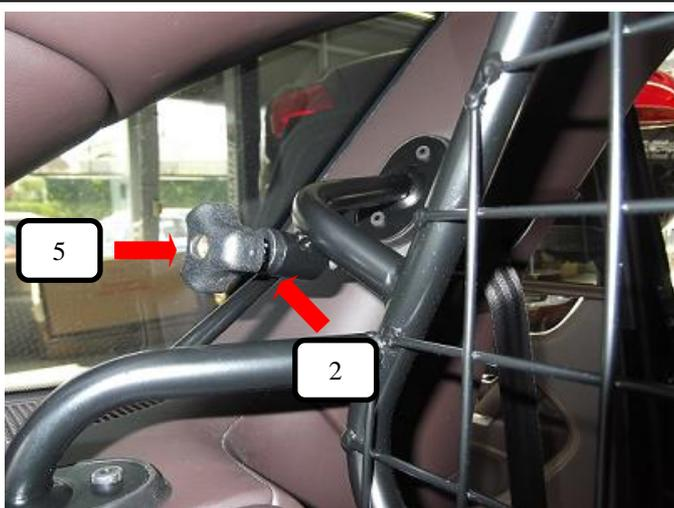
Rändelmutter gewölbt (Pos. 5) auf den Gewindehaken (Pos. 2) drehen und anziehen.
