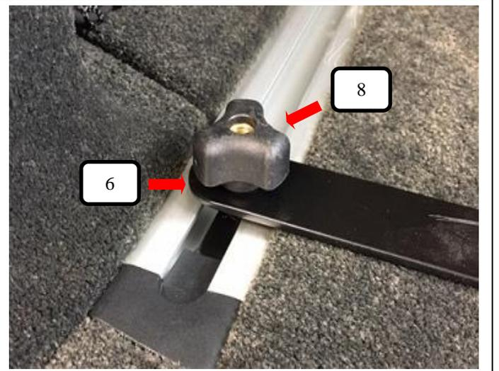
Dann mit einer Unterlegscheibe (Pos. 6) und einer Rändelmutter flach (Pos. 8) festziehen.
