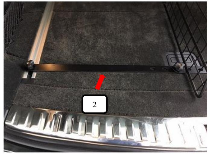
Bodenhalter (Pos. 2) im montierten Zustand.
