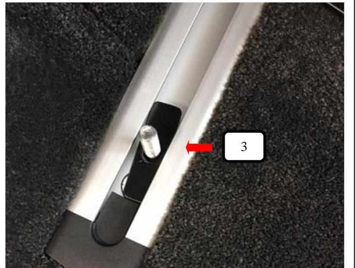
Die Gegenplatte mit angeschweißter M8x30 Maschinenschraube (Pos. 3) wie auf Bild 2 in die Ladeschienen einführen und leicht seitlich drehen.
