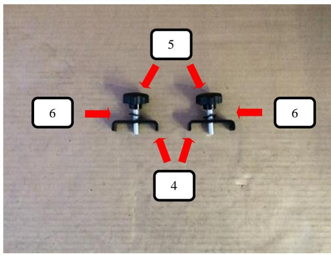
Die beiden U-Bügel (Pos. 4) zusammen mit jeweils einer Unterlegscheibe (Pos. 6) und Rändelschraube (Pos. 5) wie im Bild dargestellt zusammenbauen.
