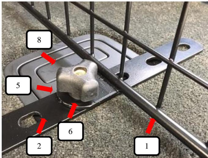
Von unten die Schlossschraube (Pos. 5) durch den Bodenhalter (Pos. 2) und den Raumteiler (Pos. 1) stecken, jetzt mit der Unterlegscheibe (Pos. 6) und der Rändelmutter flach (Pos. 8) festziehen
