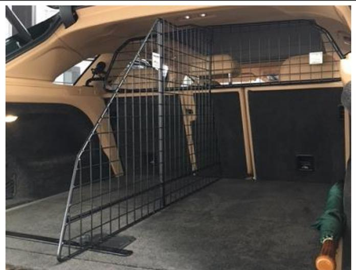
Raumteiler (Pos. 1) im montierten Zustand.
