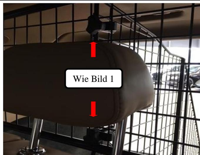
Nun den Raumteiler (Pos. 1) mittels der beiden Verschraubungen aus Bild 2 oben und unten am Trenngitter befestigen.
