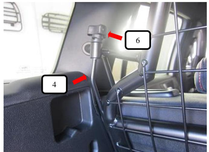
Rändelmutter gewölbt (Pos. 6) auf den Gewindehaken (Pos. 4) aufschrauben und festziehen. Nun können auch Bodenhalterungen L+R (Pos. 3) festgezogen werden !
