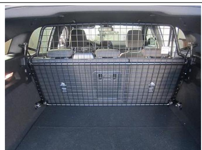
Trenngitter im montierten Zustand.
