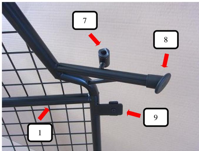
Kunststoffhülse (Pos. 7) in das und Schutzkappe 25° (Pos. 8) sowie Gummiauflage klein (Pos. 9) auf das Trenngitter (Pos. 1) anbringen.
