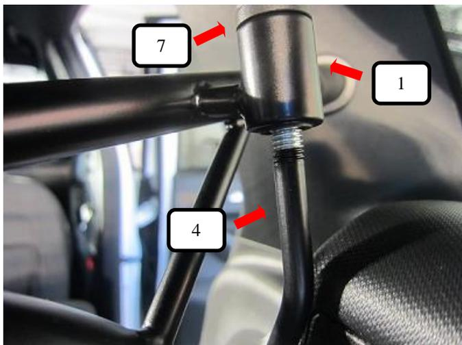
Trenngitter (Pos. 1) nach oben heben und den Gewindehaken (Pos. 4) durch das Trenngitter (Pos. 1) und die Kunststoffhülse (Pos. 7) führen.
