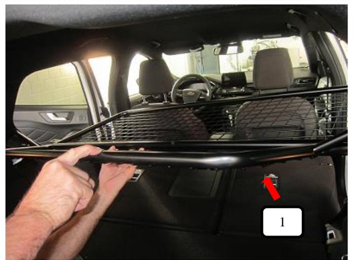
Trenngitter (Pos. 1) wie auf dem Bild von vorne schräg in das Fahrzeug einbringen.
