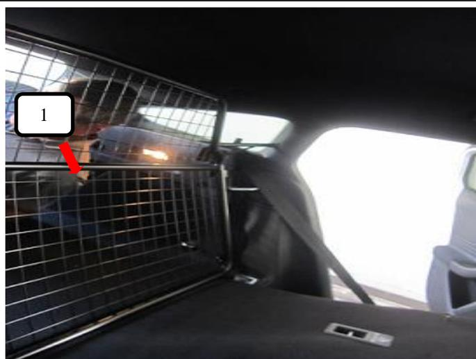
Trenngitter (Pos. 1) wie auf dem Bild aufrecht aufstellen und an der C-Säule in Position bringen.
