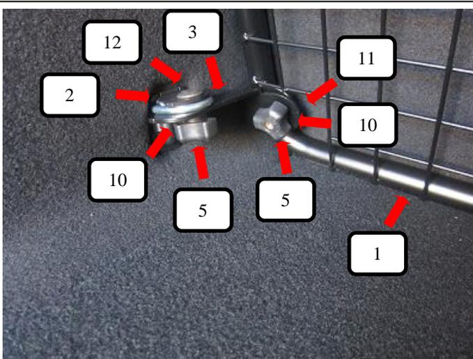
Verzurröse im Fahrzeug waagrecht stellen, von oben die Gegenplatte (Pos. 2) auflegen und die Schlossschraube (Pos. 12) durchstecken. Von unten die Bodenhalterung L+R (Pos. 3) halten und eine Unterlegscheibe (Pos. 10) und Rändelmutter flach (Pos. 5) aufschrauben und festziehen. Jetzt von vorne eine Schlossschraube (Pos. 11) durch das Trenngitter (Pos. 1) und die Bodenhalterung L+R (Pos. 3) stecken, eine Unterlegscheibe (Pos. 10) und Rändelmutter flach aufschrauben und festziehen.
