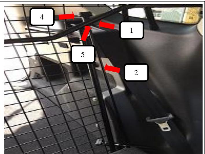
Gewindehaken 8 x 597mm (Pos. 2), durch das Trenngitter (Pos. 1) und Kunststoffhülse (Pos. 5) schieben, dabei an der Verzuröse einhängen. Dann die Rändelmutter gewölbt (Pos. 4) darauf drehen und anziehen.
