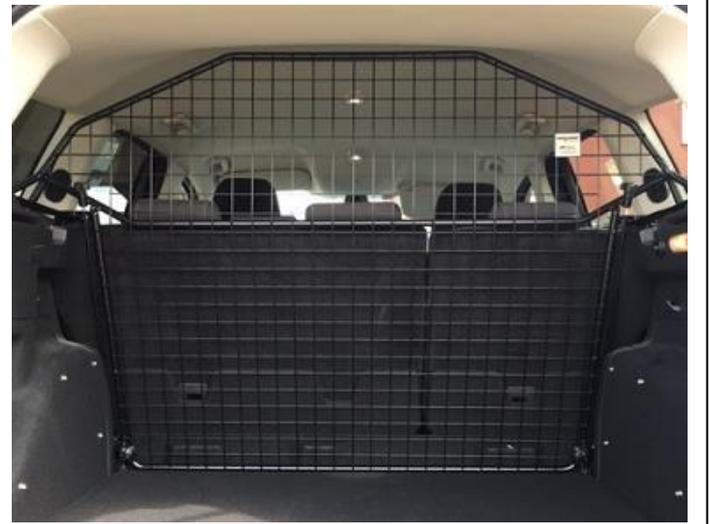
Trenngitter im montierten Zustand.
