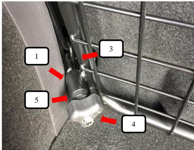
Gewindehaken 8 x 84mm (Pos. 3), durch das Trenngitter (Pos. 1) und Kunststoffhülse (Pos. 5) schieben, dabei an der Verzüröse einhängen. Dann die Rändelmutter gewölbt (Pos. 4) darauf drehen und anziehen.
