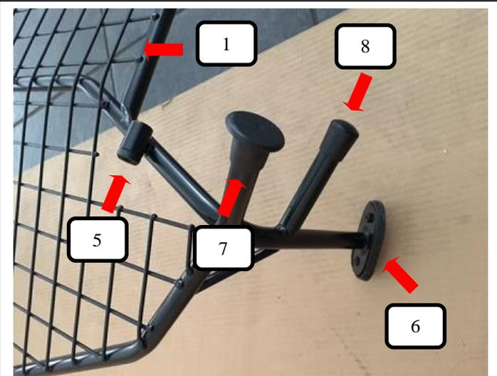
Gummifuß (Pos. 6), Schutzkappe 25° (Pos. 7), Rohrendkappe 16mm (Pos. 8) auf das und die Kunststoffhülse (Pos. 5) in das Trenngitter (Pos. 1) stecken.
