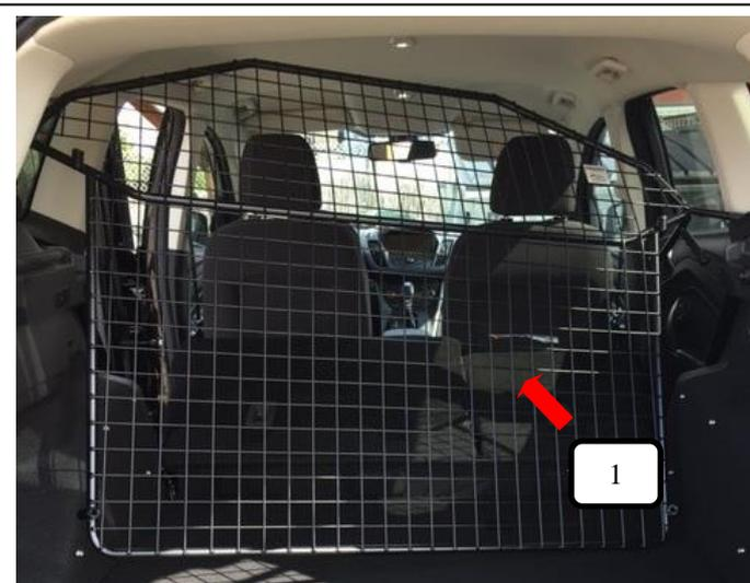
Trenngitter (Pos. 1) schräg in das Fahrzeug einbringen und platzieren.
