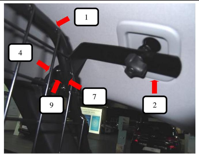
Trenngitter (Pos. 1) in das Fahrzeug einbringen, mit einer Schlossschraube (Pos. 7), Unterlegscheibe (Pos. 9) und Rändelmutter flach (Pos. 4) das Trenngitter (Pos. 1) mit dem Dachhalter mit Knick (Pos. 3) befestigen.
