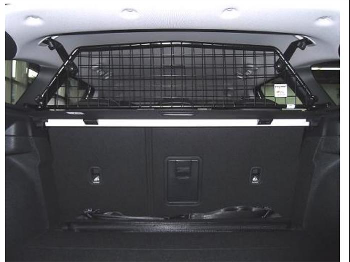
Trenngitter (Pos. 1) im montierten Zustand.
