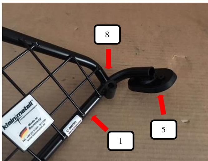
Gummifuß (Pos. 5) auf das Trenngitter (Pos. 1) und Kunststoffhülse (Pos. 8) in das Trenngitter (Pos. 1) stecken.
