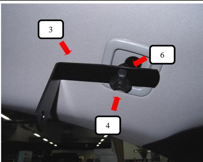
Dachhalter mit Knick (Pos. 3) wie auf Bild 2 vormontiert, mit der Schlossschraube (Pos. 6) in die vorhandenen Netzaufhängungen einhängen und mit der Rändelmutter flach (Pos. 4) festziehen.
