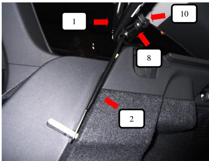
Gewindehaken links + rechts (Pos. 2) über die Rücksitzbankverankerung stecken, dann durch das Trenngitter (Pos. 1) und die Kunststoffhülse (Pos. 8) führen. Rändelmutter gewölbt (Pos. 10) auf den Gewindehaken (Pos. 2) aufschrauben und festziehen.
