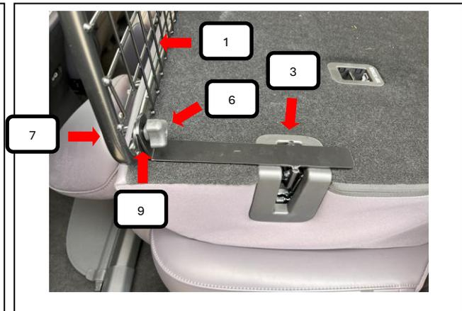
Trenngitter (Pos. 1) von der Seite aus in das Fahrzeug einbringen und vor die Bodenhalter (Pos. 3) stellen. Jetzt von vorne eine Schlossschraube M8x20 (Pos. 7) durch das Trenngitter (pos. 1) und den Bodenhalter (Pos. 3) stecken, von der andere Seite eine Unterlegscheibe M8 (Pos. 8) und Rändelmutter flach (Pos. 6) aufschrauben und festziehen.
