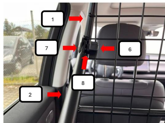
Auf der anderen Seite die Strebe L+R (Pos. 2) von innen an das Trenngitter (Pos. 1) halten. Jetzt von außen eine Schlossschraube M8x20 (Pos. 7) durchstecken und von der anderen Seite eine Unterlegscheibe M8 (Pos. 8) und Rändelmutter flach (Pos. 6) aufschrauben und festziehen.
