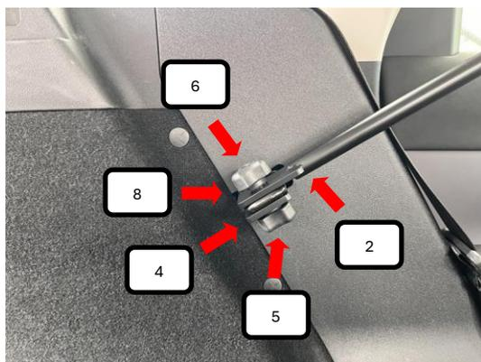
Strebe L+R (Pos. 2) von oben auf die Rücksitzbankretirung halten, nun von unten eine Rändelschraube M8x30 (Pos. 5) und eine Gegenplatte (Pos. 4) durch die Strebe L+R (Pos. 2) führen. Von oben eine Unterlegscheibe M8 (Pos. 8) und Rändelmutter flach (Pos. 6) aufschrauben und festziehen.
