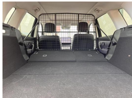
Trenngitter im montierten Zustand.
