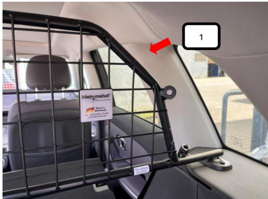
Trenngitter (Pos. 1) schräg von hinten aus in das Fahrzeug einbringen und hinter der C-Säule platzieren.
