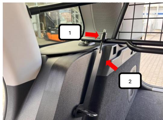
Gewindehaken L+R (Pos. 2) über die Rücksitzbankretterung führen, jetzt das Trenngitter (Pos. 1) etwas anheben und den Gewindehaken L+R (Pos. 2) durch führen.
