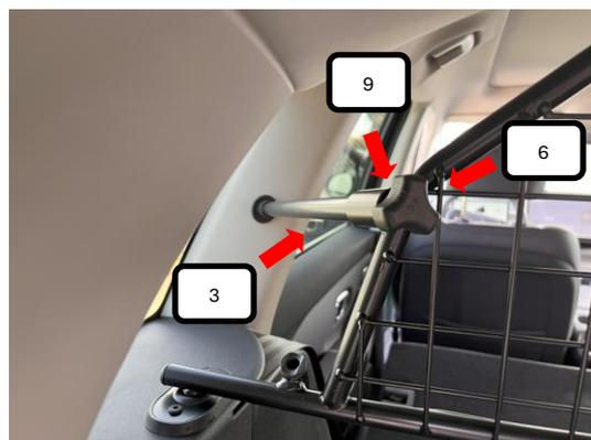
Von der anderen Seite die Rändelschraube M8x30 (Pos. 6) mit einer Unterlegscheibe M8 (Pos. 9) in das 16er Rohr mit Innengewinde (Pos. 3) drehen und festziehen.
