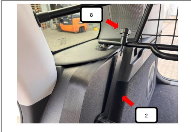
Nun die Rändelmutter gewölbt (Pos. 8) auf den Gewindehaken L+R (Pos. 2) drehen und festziehen.
