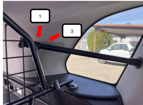
Jetzt das 16er Rohr mit Innengewinde (Pos. 3) wie auf dem Bild in das Trenngitter (Pos. 1) stecken, so das sich die andere Seite an der C-Säule abstützt.
