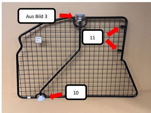
Wie im Bild dargestellt, bitte die aus Bild 3 zusammengesteckte Gewindestange mit Gummifuß oben in die Rohröffnung des Teilers (Pos. 1) stecken (Feststellpunkt) und einen Gummifuß (Pos.10) unten am Teiler aufstecken. Beide Rohrendkappen (Pos. 11) auf den Raumteiler drücken.
