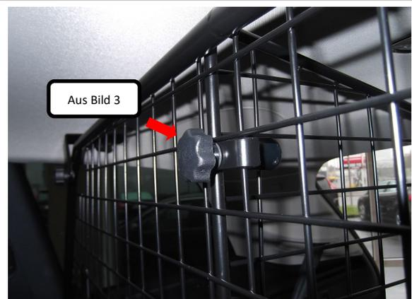
Nun den Teiler mittels der beiden Verschraubungen aus Bild 4 oben und unten am Trenngitter befestigen.
