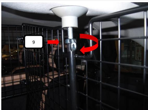
Oberen Feststellpunkt über drehen der Flügelmutter (Pos. 9) (Uhrzeigersinn) leicht anziehen.
