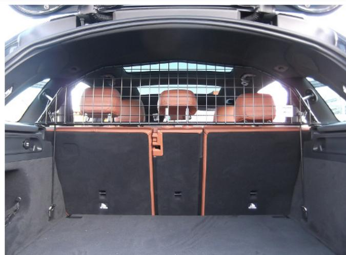
Trenngitter final ausrichten und festschrauben, Rücksitzbank wieder hochklappen.
