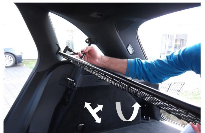
Wie in den Bildern 2 und 3 Trenngitter vom Kofferraum aus schräg nach vorne Richtung Rücksitzbank, dann wie im Bild dargestellt fast waagrecht und in Schräglage vorsichtig nach hinten zwischen die Fenster ziehen und langsam aufstellen und ausrichten.
