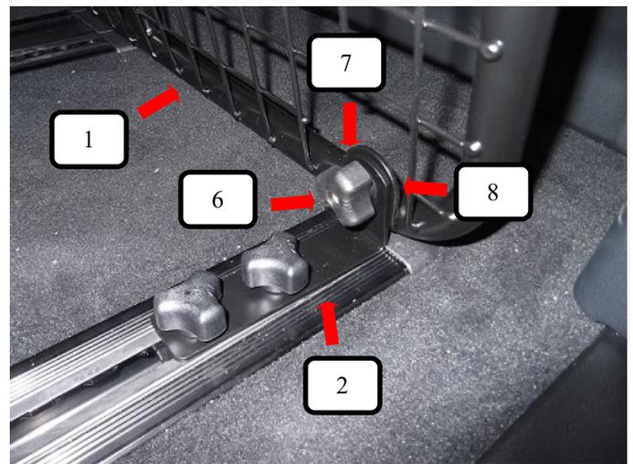
Bodenhalter (Pos. 2) mit einer Schlossschraube (Pos. 8), Unterlegscheibe (Pos. 7) und Rändelmutter flach (Pos. 6) am Trenngitter (Pos. 1) befestigen und festziehen.
