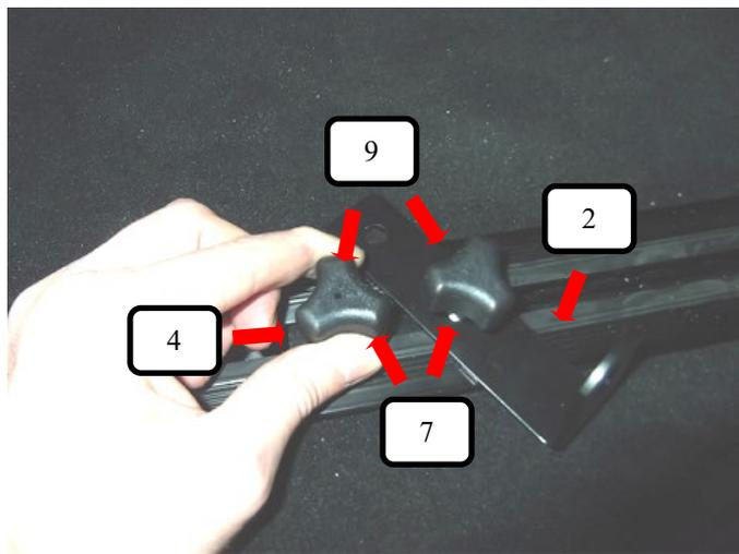
Bodenhalter (Pos. 2) mit der Rändelschraube (Pos. 9), Unterlegscheibe (Pos. 7) und der Gewindeplatte (Pos. 4) verbinden. Jetzt die andere Rändelschraube (Pos. 9) wieder rausdrehen und dann auch mit dem Bodenhalter (Pos. 2) verbinden und festziehen.
