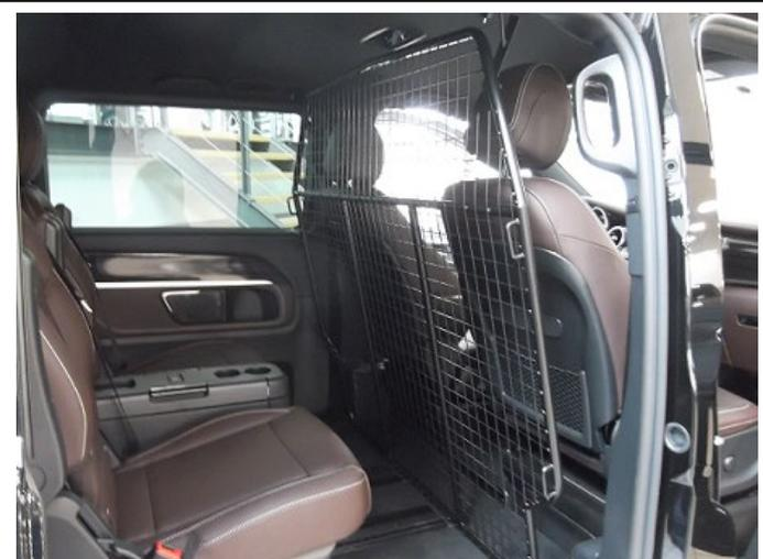
Trenngitter im montiert hinter den Vordersitzen (B-Säule).
