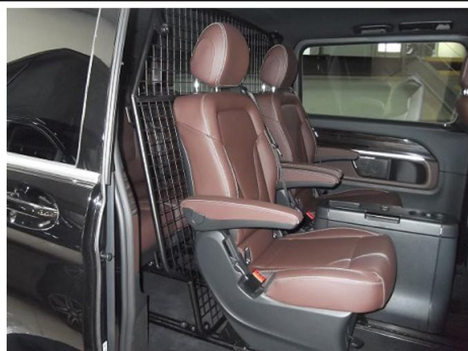
Trenngitter montiert hinter der 1. Rücksitzreihe (C-Säule).
