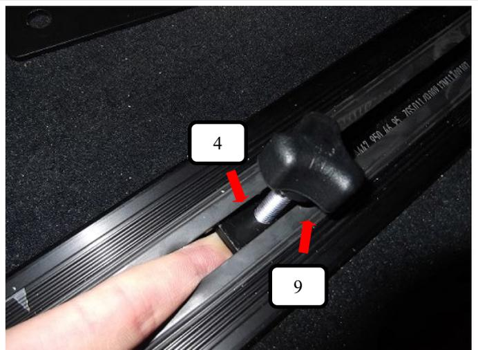
Gewindeplatte (Pos. 4) in die Ladeschienen legen und von unten mit dem Finger nach oben drücken, jetzt die Rändelschraube (Pos. 9) leicht reindreihen.
