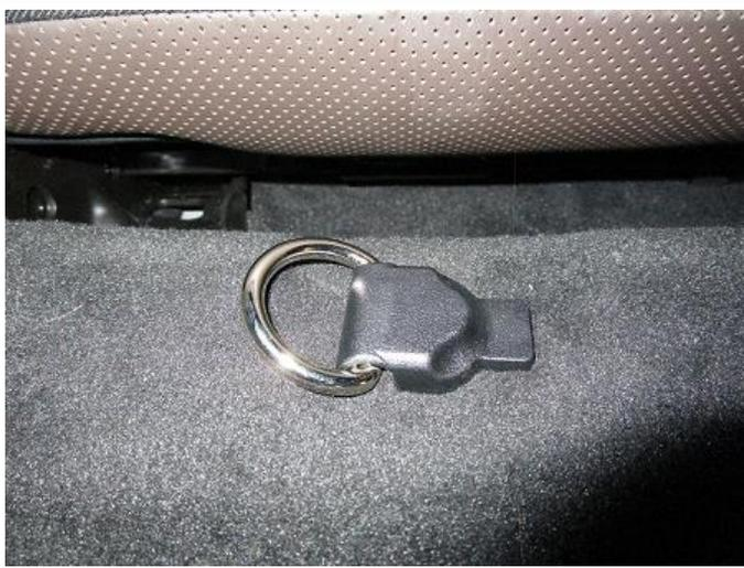
Verzurröse rechts + links vor der Rücksitzbank entfernen und die Originalschraube zur Seite legen, diese wird für die Befestigung des Bodenhalter (Pos. 3) benötigt.
