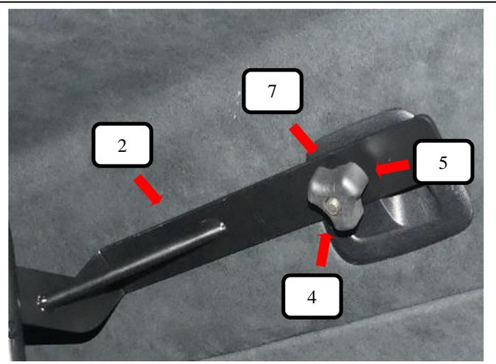
Dachhalter links + rechts (Pos. 2) mit einer Schlossschraube (Pos. 7) Unterlegscheibe (Pos. 5) und Rändelmutter flach (Pos. 4) wie auf dem Bild in die im Dach vorhandenen Netzaufhängungen-Vorrichtungen einhängen und festziehen.
