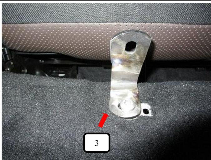
Bodenhalter (Pos. 3) mit der Originalschraube wie auf dem Bild rechts und links befestigen.
