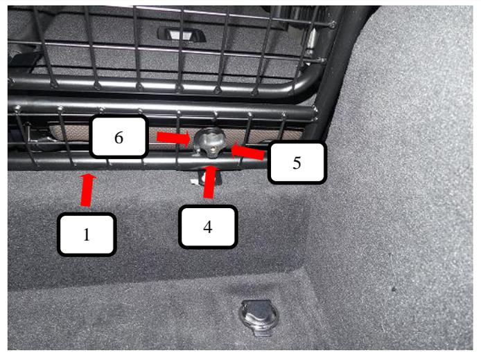
Trenngitter (Pos. 1) und Bodenhalter (Pos. 3) mit einer Schlossschraube (Pos. 6), Unterlegscheibe (Pos. 5) und Rändelmutter flach (Pos. 4) verbinden und festziehen.
