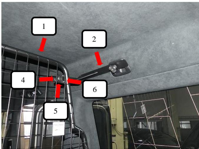
Trenngitter (Pos. 1) von hinten in das Fahrzeug einbringen. Das Trenngitter (Pos. 1) und den Dachhalter (Pos. 2) links + rechts mit einer Schlossschraube (Pos. 6), Unterlegscheibe (Pos. 5) und Rändelmutter flach (Pos. 4) verbinden und festziehen.
