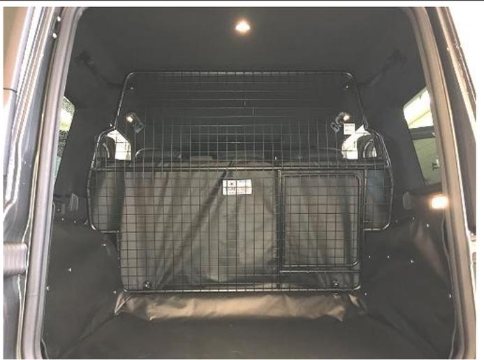
Trenngitter im montierten Zustand.
