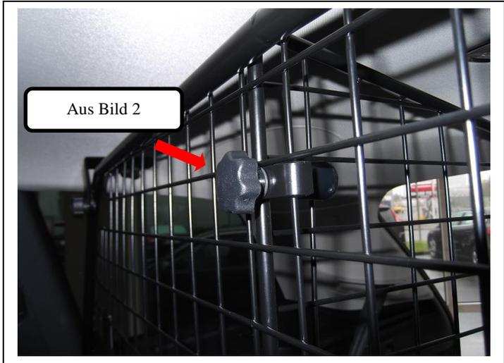
Nun den Teiler mittels der beiden Verschraubungen aus Bild 2 oben und unten am Trenngitter befestigen.
