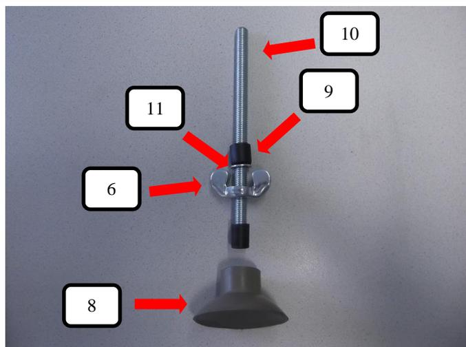
Die Gewindestange oben (Pos.10) auf einen Gummifuß grau (Pos.8) wie im Bild dargestellt auf stecken. Danach die Flügelmutter (Pos. 6) drauf drehen und die Unterlegscheibe (Pos. 11), sowie die Distanzhülse (Pos. 9) aufstecken.
