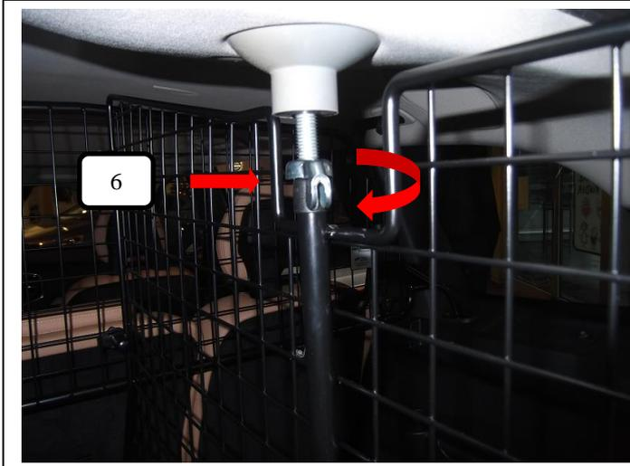
Oberen Feststellpunkt über drehen der Flügelmutter (Pos. 6) (Uhrzeigersinn) leicht anziehen.
