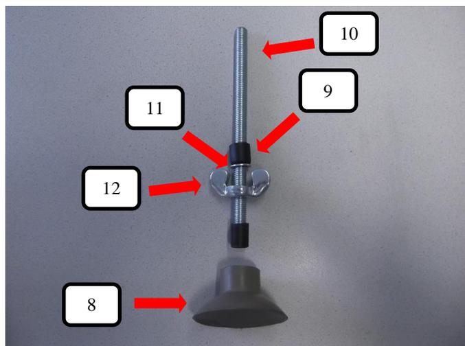
Die Gewindestange oben (Pos.10) auf einen Gummifuß grau RM (Pos.8) wie im Bild dargestellt aufstecken. Danach die Flügelmutter (Pos. 12) drauf drehen und die Unterlegscheibe (Pos. 11), sowie die Distanzhülse (Pos. 9) aufstecken.
