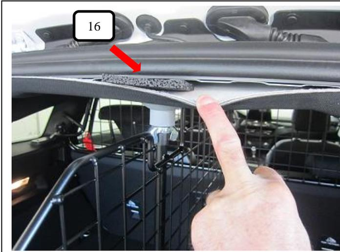
Im oberen Bereich der Hecktür die Gummiabdichtung leicht anheben und je nach gewünschter Position des Teilers 1 x Gummimatte 8mm (Pos.6) im Bereich des Feststellpunktes in den Hohlraum schieben.
