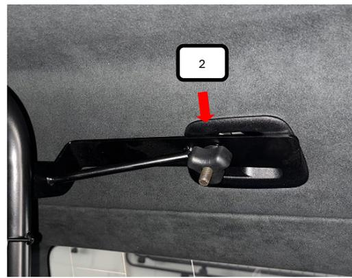
Vormontierten Dachhalter L+R (Pos. 2) aus Bild 3, in die Original-Netzaufhängungen einhängen und festziehen.
