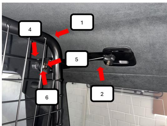
Dachhalter L+R (Pos. 2) und Trenngitter (Pos. 1) mit einer Schlossschraube M8x20 (Pos. 5), Unterlegscheibe M8 (Pos. 6) und Rändelmutter flach (Pos. 4) verbinden und festziehen.
