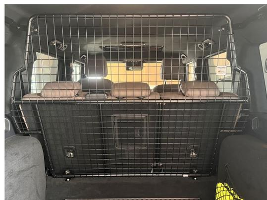
Trenngitter im montierten Zustand.
