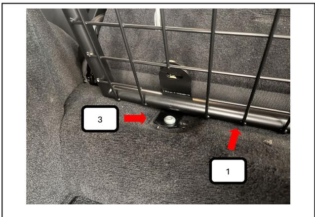
Original-Verzurrösen im Fahrzeug entfernen. Jetzt den Bodenhalter (Pos. 3) mit der Original-Schrauben befestigen und festziehen. Nun das Trenngitter (Pos. 1) in das Fahrzeug einbringen.
