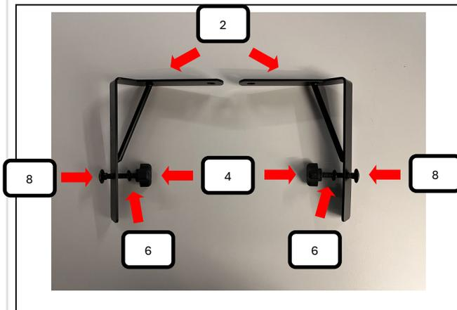
Dachhalter L+R (Pos.2) wie auf dem Bild mit jeweils einer Schlossschraube M8x50 (Pos. 8), Unterlegscheibe M8 (Pos. 6) und Rändelmutter flach (Pos. 4) vormontieren.
