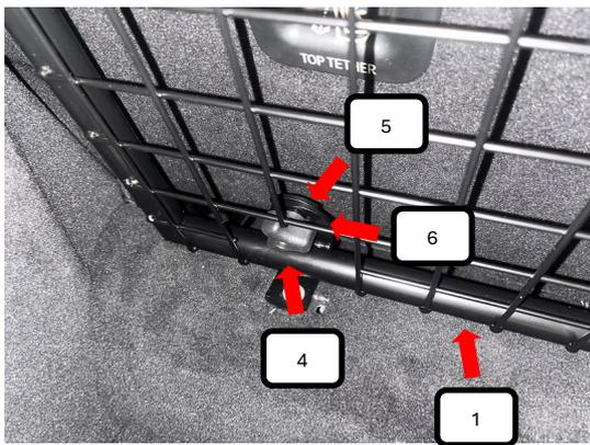
Trenngitter (Pos. 1) und Bodenhalter (Pos. 3) mit einer Schlossschraube M8x20 (Pos. 5), Unterlegscheibe M8 (Pos. 6) und Rändelmutter flach (Pos. 4) verbinden und festziehen.
