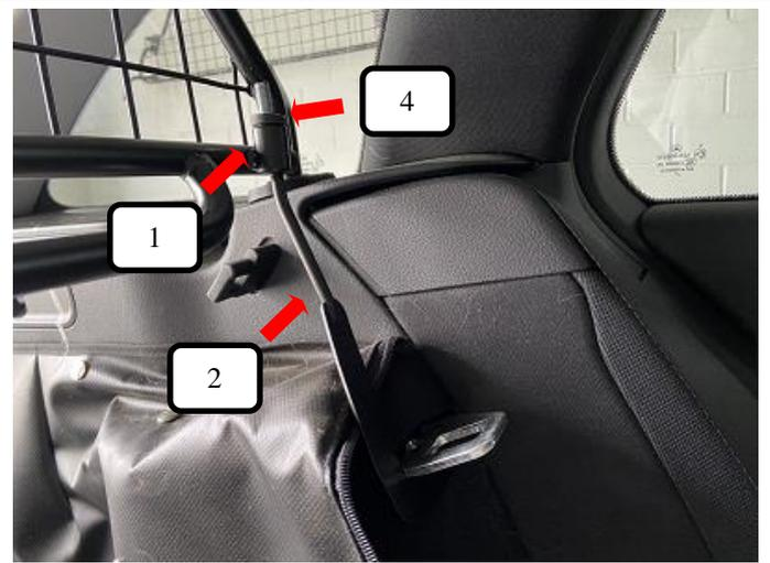
Kunststoffhülle (Pos. 4) in das Trenngitter (Pos. 1) und Gummifuß 25° (Pos. 5) sowie Gummiauflage groß (Pos. 6) auf das Trenngitter (Pos. 1) stecken.
