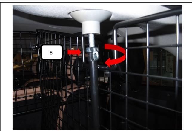
Oberen Feststellpunkt über drehen der Flügelmutter (Pos. 8) (Uhrzeigersinn) leicht anziehen.
