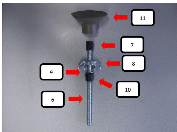
Auf die Gewindestange oben (Pos.6) die Distanzhülse (Pos. 7) und danach den Gummifuß (Pos. 11) aufstecken. Von der anderen Seite die Flügelmutter (Pos. 8) aufdrehen und dann die U-Scheibe (Pos. 9) und Durchführungsschutzkappe (Pos. 10) aufschieben.
