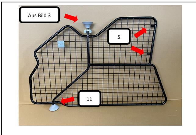
Wie im Bild dargestellt bitte die aus Bild 3 zusammengesteckte Gewindestange mit Gummifuß oben in die Rohröffnung des Teilers (Pos. 1) stecken (Feststellpunkt) und einen Gummifuß (Pos.11) unten am Teiler aufstecken. Beide Röhrendkappen (Pos. 5) auf den Raumteiler drücken.
