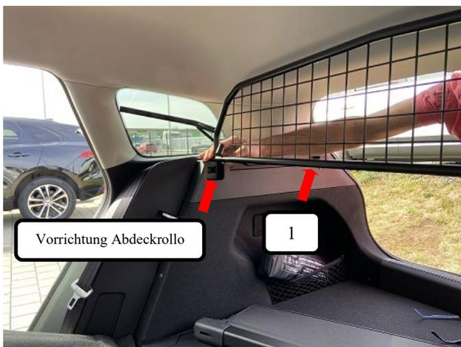
Jetzt das Trenngitter (Pos. 1) nach hinten drehen und das so, dass die seitlichen Halter am Trenngitter (Pos. 1), in die Vorrichtung für den Abdeckrollo sind.
