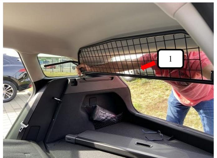
Trenngitter (Pos. 1) von hinten aus schräg in das Fahrzeug einbringen, beim einbringen muss das Trenngitter (Pos. 1) etwas nach vorne geneigt werden.
