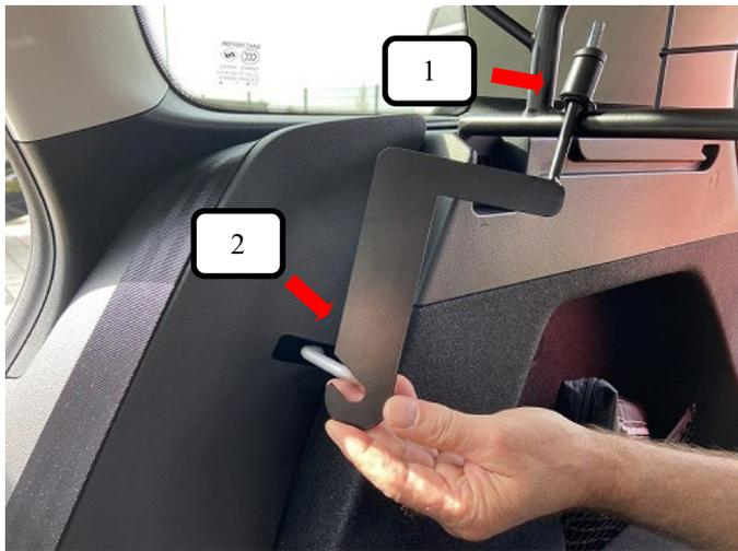
Nun die Gewindehaken L+R (Pos. 2) wie auf dem Bild durch das Trenngitter (Pos. 1) schieben, bis zur dargestellten Position.
