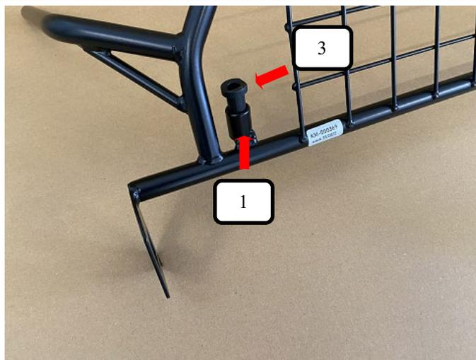
Kunststoffhülse (Pos. 3) in das Trenngitter (Pos. 1) stecken.
