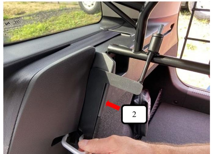
Jetzt den Gewindehaken L+R (Pos. 2) nach außen drehen, so dass er sich in die Rücksitzbankverankerung einhängt.
