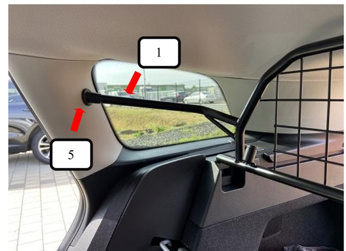
Jetzt jeweils rechts und links die Schutzkappe 25° (Pos. 5), auf das Trenngitter (Pos. 1) stecken.
