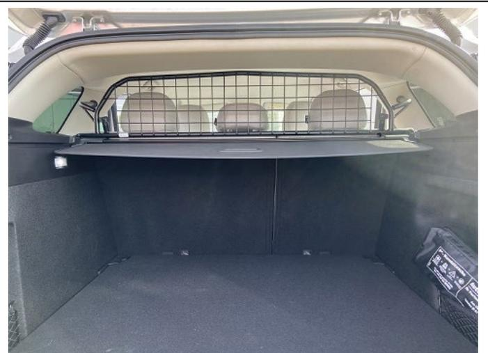
Nach der Montage muss der Abdeckrollo zur Stabilisierung eingesetzt werden !
