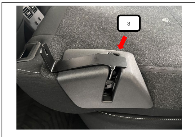
Bodenhalter (Pos. 3) wie auf dem Bild in die Rücksitzarretierung einklinken.
