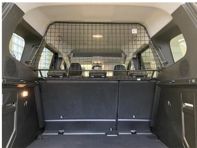
Trenngitter im montierten Zustand.
