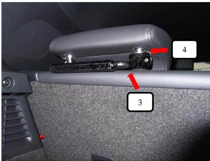
Ausgleichshülsen Nr. 14 (Pos. 4) in den Kopfstützenhalter mit Schrauben (Pos. 3) stecken, dann die Kopfstützenstangen durchstecken und wieder in die Rücksitzbank einführen. Jetzt die Schrauben des Kopfstützenhalters mit Schrauben (Pos. 3) anziehen.
