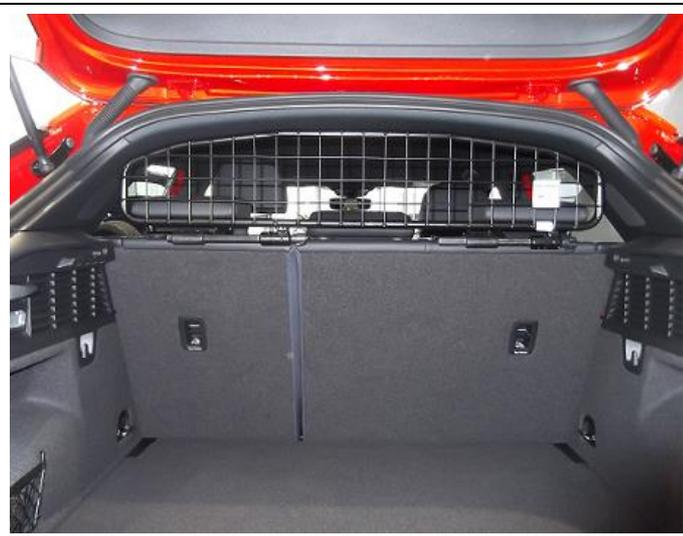
Trenngitter im montierten Zustand.
