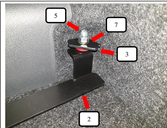
Bodenhalter (Pos. 2) wie auf dem Bild unter die Verzurrösen führen, von oben die Gegenplatte (Pos. 3), Unterlegscheibe (Pos. 7) und Hutmutter M8 (Pos. 5) aufschrauben und festziehen.
