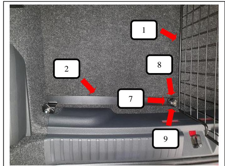
Raumteiler (Pos. 1) in das Fahrzeug einbringen. Den Bodenhalter (Pos. 2) mit einer Schlossschraube (Pos. 8), Unterlegscheibe (Pos. 7) und Rändelmutter flach (Pos. 9) am Raumteiler (Pos. 1) befestigen.
