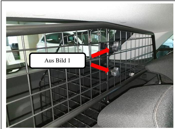
Den Raumteiler (Pos. 1) mittels der beiden Verschraubungen aus Bild 1 oben und unten am Trenngitter befestigen.
