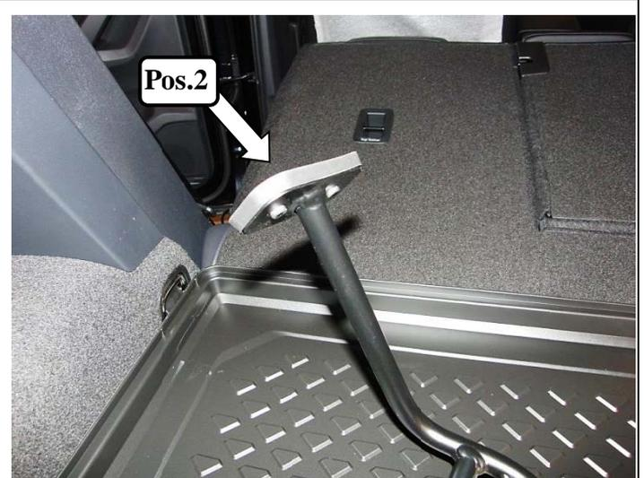
Gummiauflagen Pos.2 mit den Zapfen in die Bohrungen der Auflageplatten am Trenngitter drücken.
