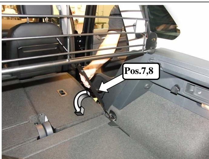
Trenngitter in das Fahrzeug einbringen, und Montagestreben Pos.7&8, von vorne in die Ladehaken einhaken.
