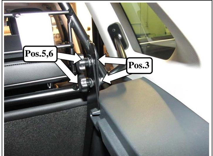
Streben Pos. 7&8 mit Rundkopfschrauben Pos. 3, Rändelmuttern Pos. 6, und U-Scheiben Pos.5 montieren. Trenngitter nach vorne drücken, und dann die Schrauben richtig anziehen. Das Gitter soll sich so gegen die C-Säulenverkleidung verspannen.
