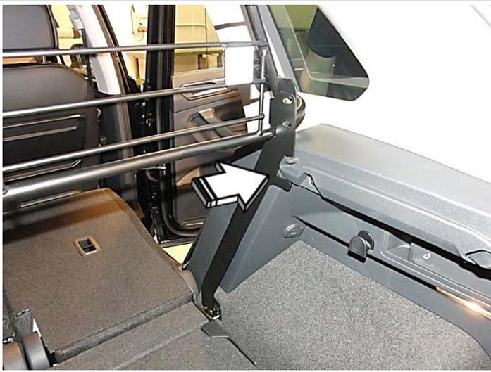
Montagestreben Pos.7&8 unter dem Trenngitter nach hinten, und zur Seite (Seitenverkleidung) schwenken.
