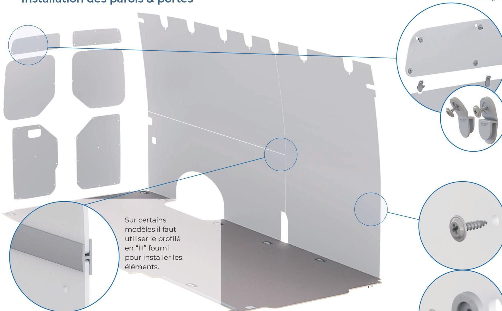
Sur certains modèles il faut utiliser le profilé en "H" fourni pour installer les éléments.
