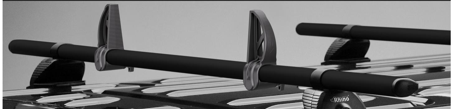
Touche finale à notre solution de barres de toit haute de gamme, tous les systèmes KammBar Black sont dotés en standard de deux paires de butées de charge.
