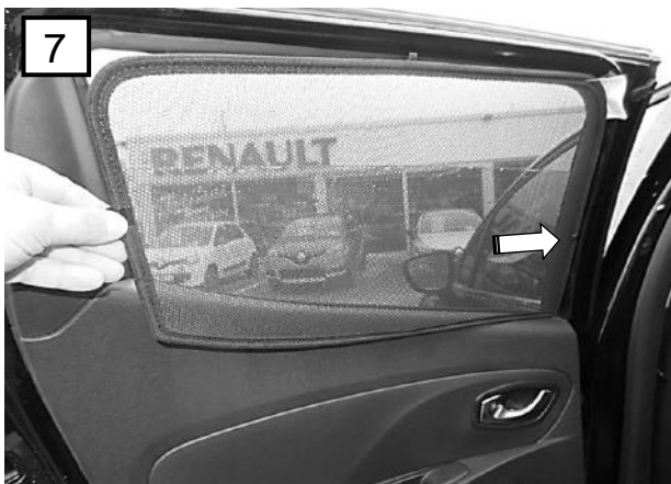
Der Halter wird unter dem Gummi auf das Blech gesteckt
